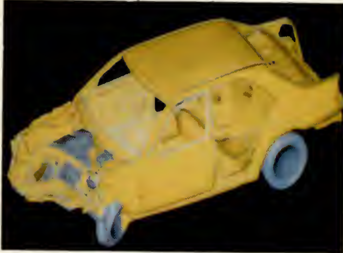
تجارب تصادم السيارة المصممة بالحائط على شاشة الحاسوب الذي يقدم معلومات متكاملة عن القطع الضعيفة في هيكلها
